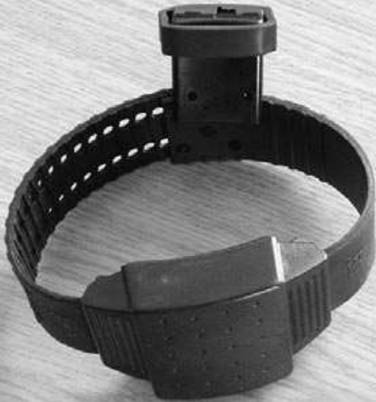
Die „Fußfessel“ – etwas größer als eine Armbanduhr – die typischerweise oberhalb des Knöchels getragen wird.
